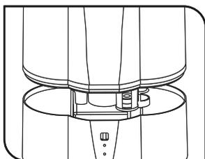
**2.** Rosqueie a tampa, certifique-se que não há vazamento pela vedação da rosca, encaixe o reservatório de água sobre o gabinete, conecte o aparelho na tomada, pressione o botão localizado no painel frontal do aparelho. No primeiro toque seu aparelho irá ligar na intensidade “mínima”. No segundo toque irá para a “média” e no terceiro toque para a “máxima” (Turbo).
