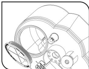
**1.** Antes de ligar o aparelho na rede elétrica, retire o reservatório de água, desrosqueie a tampa abaixo e abasteça-o com água, até o limite indicado no aparelho.
